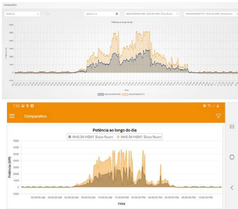
Gráfico comparativo de potência ao longo do dia entre dois equipamentos distintos (Web e App).
